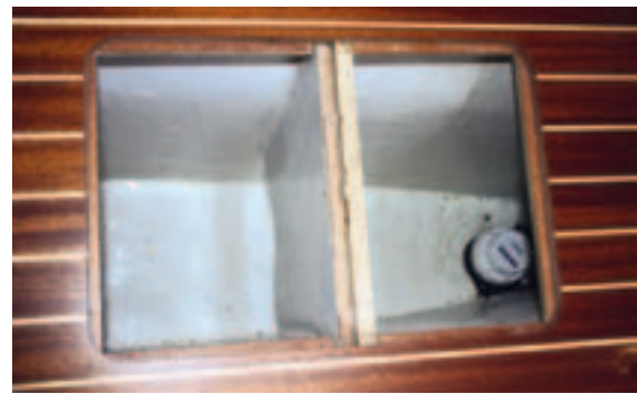
Die Bilge ist sehr tief und kann als zusätzlicher Stauraum benutzt werden
